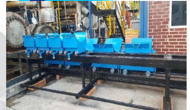
DISEÑO, FABRICACIÓN Y POSICIONAMIENTO DE SOPORTES EN UNIDADES METÁLICAS.
